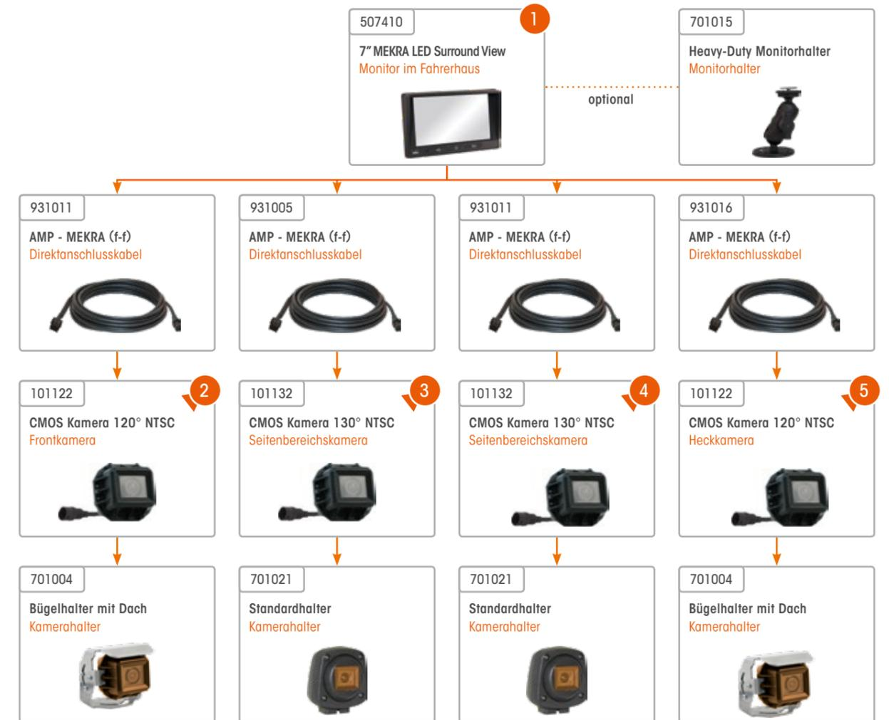
Einbauschema für mehr Effizienz und sicheres Arbeiten
