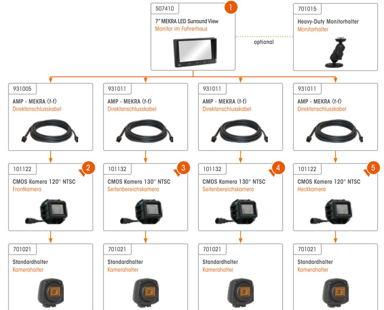
Einbauschema für mehr Effizienz und sicheres Arbeiten
